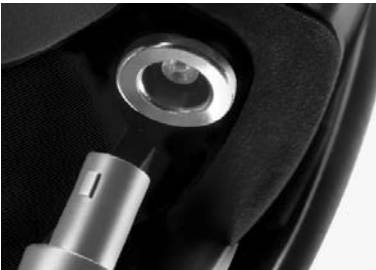
高精度ODU插头保证稳定的信号传输并提供灵活的连接选择。
