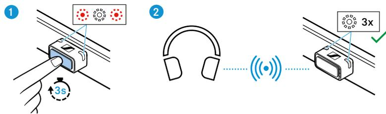
Quando il dongle è accoppiato con le cuffie Bluetooth, i LED di stato sull'involucro del dongle lampeggiano tre volte bianco.
